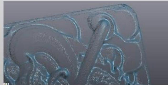
□ Cuando escaneamos piezas normalmente debemos elegir entre los 2 modos que tiene nuestro equipo: Escaneo de superficie o Escaneo de nube de puntos, ambos modos de escaneo recolectan información de nuestra superficie.
